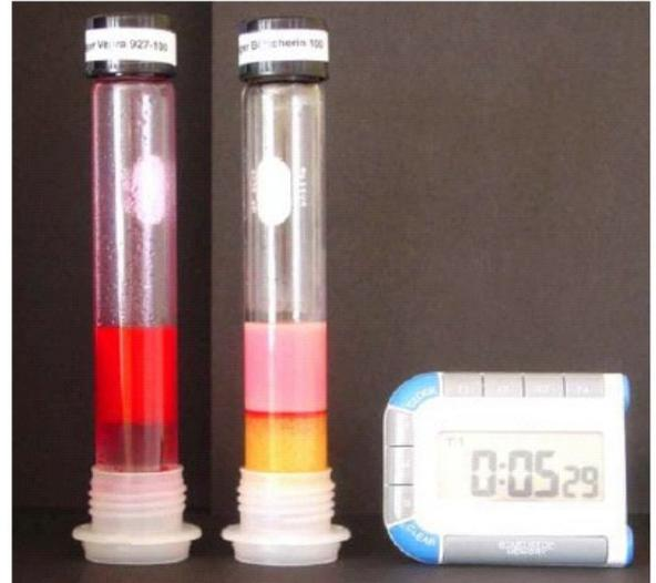
快速清洗剂E-927-100几乎将全部被溶解的油墨组集中在油相中，清晰的水相可再利用。
