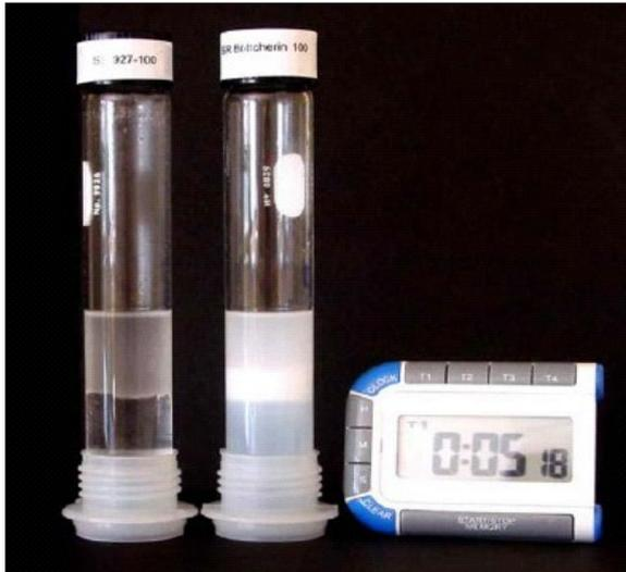
快速清洗剂E-927-100在5分钟后可分解成清晰的水相（下方）和几乎清晰的油相（上方）。
